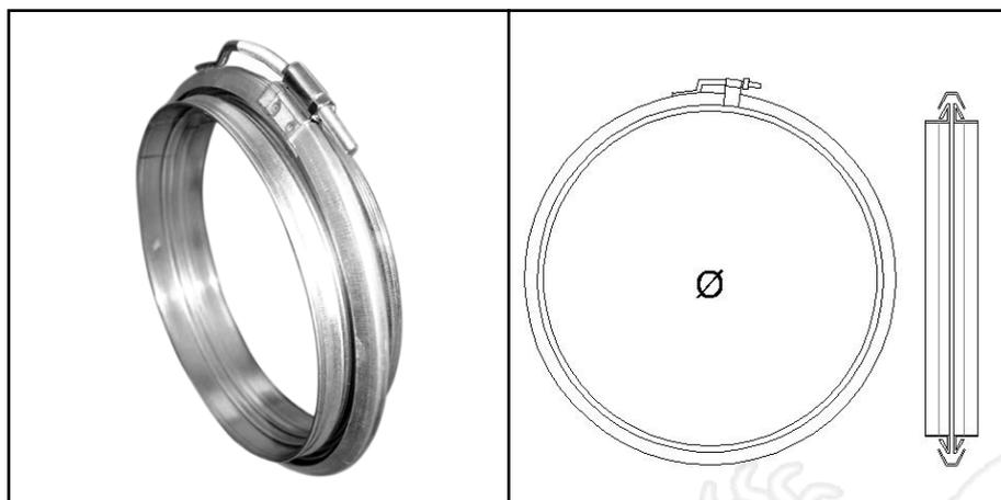
Flangia a collare è formata da due anelli che si innestano nel canale spiralato e da un collare che li congiunge e li unisce attraverso una chiusura a vite. Consigliabile dal diametro 630 per facilitare le operazioni di installazione.
