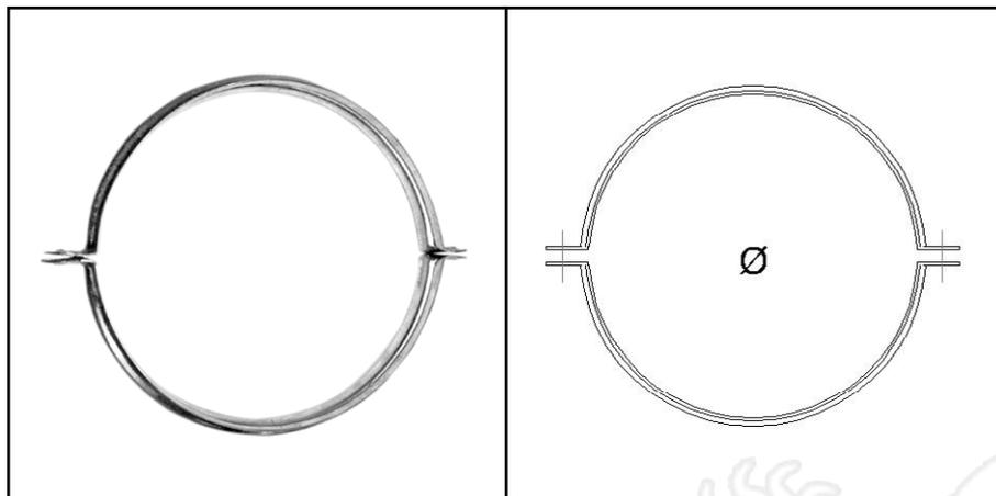
Collare semplice in lamiera d'acciaio zincato per la giunzione dei canali e dei raccordi con risvolto. Spessore 15/10.
